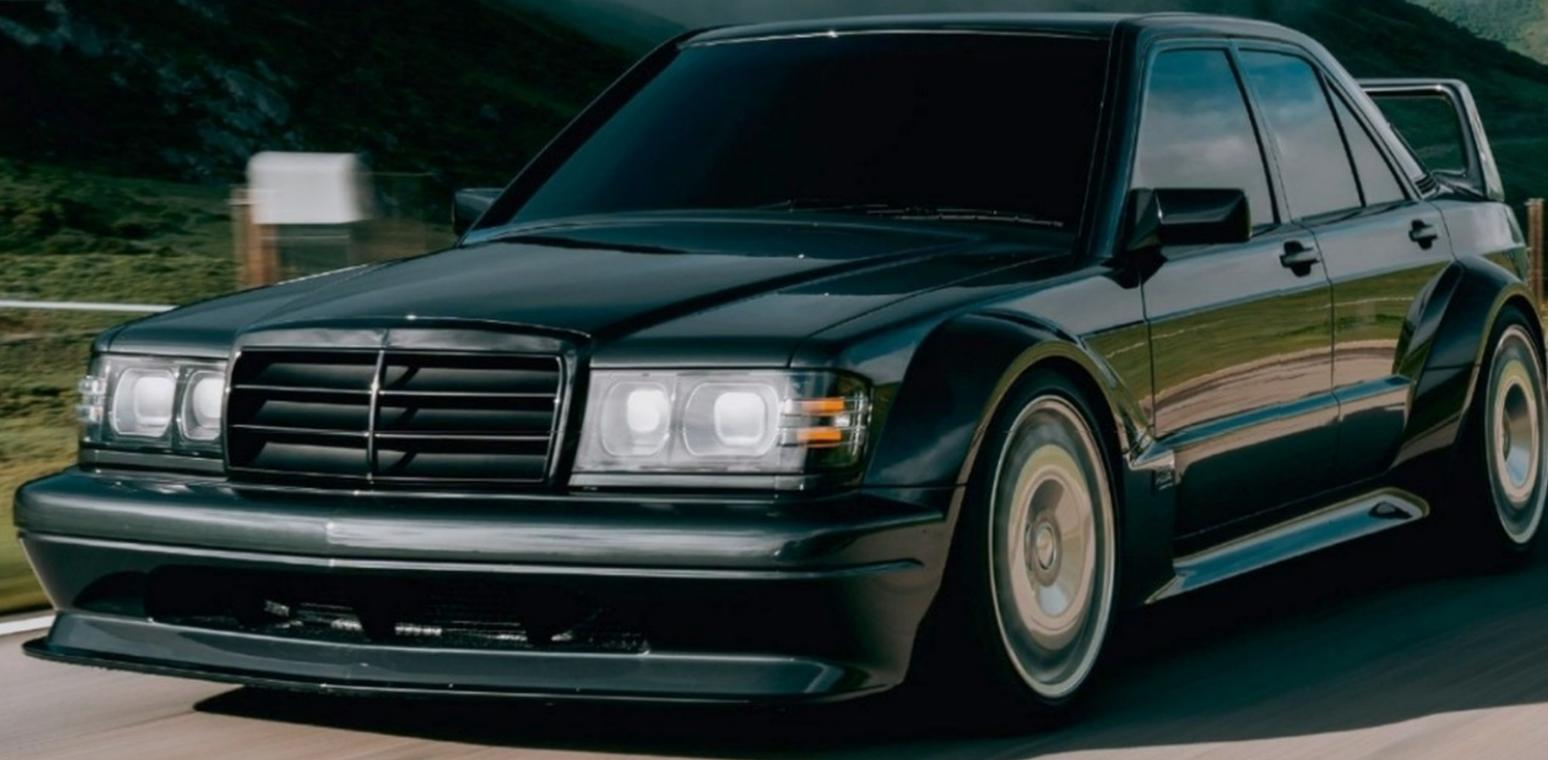
↳ ment démontée pour ne conserver que le châssis. Lequel se voit renforcé et doté d'un discret arceau de sécurité. L'essieu avant est avancé de 50 mm pour une meilleure répartition du poids. L'aérodynamique de la carrosserie (entièrement en fibre de carbone) est perfectionnée en soufflerie. Au final, la bête est plus longue et plus large que l'Evo 2 et n'arbore naturellement aucun logo Mercedes. Elle est encore plus menaçante que son aïeule, ne trouvez-vous pas ?
