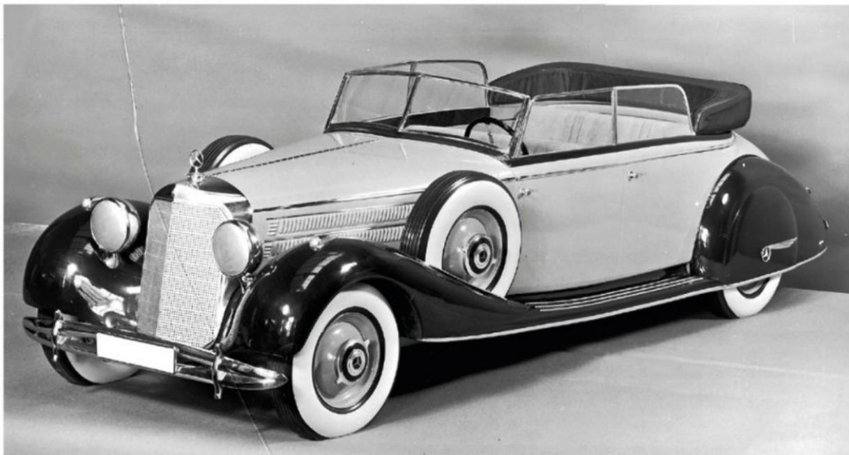
La 260 VB W146 de 1936, un cabriolet à moteur 8 cylindres à plat.
