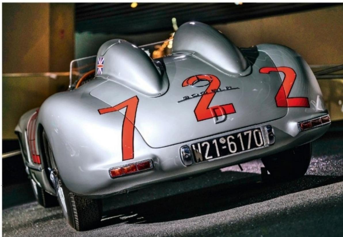
Le carénage situé du côté pilote cache un accès au réservoir d'essence et deux roues de secours logent dans le coffre.
