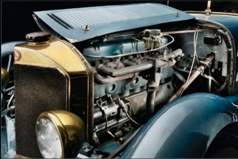
Le moteur à 8 cylindres en ligne de 5245 cm<sup>3</sup> produisait plus de 150 ch.
