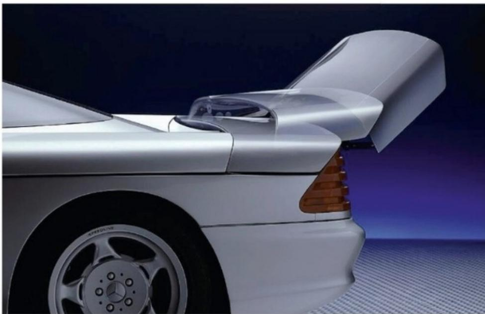
Comme sur les 300 SLR de la saison 1955, un « aero brake » s'extrait de l'arrière du proto pour optimiser le freinage.
