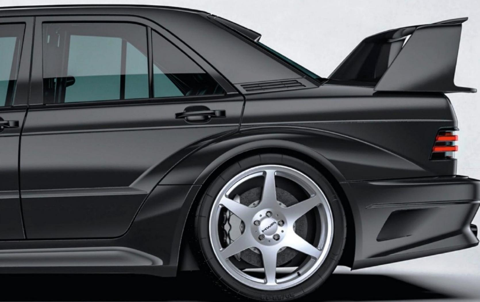
75% du châssis a été remplacé par des pièces développées par HWA, ce qui permet de doubler la rigidité par rapport à la W 201 d'origine.
